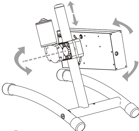
操纵手轮可控制垂直位置旋钮和头部单元的预定角度。仅需稍微松动夹紧螺栓，即可调整其当前位置。确保夹紧螺栓在每次调整后都能够充分拧紧。在松动操纵手轮时，应用一只手扶着头部单元，防止其滑出理想位置范围。
